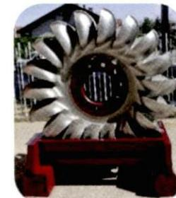
Ruota di turbina idraulica, tipo Pelton
