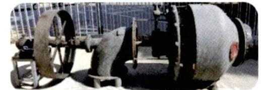
Turbina idraulica tipo Francisin camera forzata.
