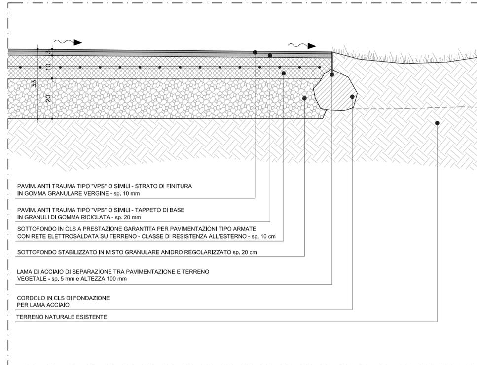
**DETTAGLIO P2.A - PAVIMENTAZIONE ARCHITETTONICA IN CLS CON LAMA ACCIAIO**
