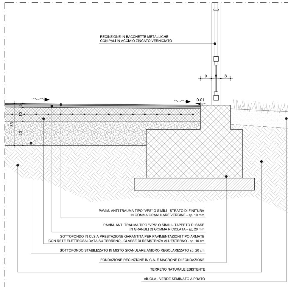
**DETTAGLIO P2.B - PAVIMENTAZIONE ARCHITETTONICA IN CLS VERSO FONDAZIONE RECINZIONE**
