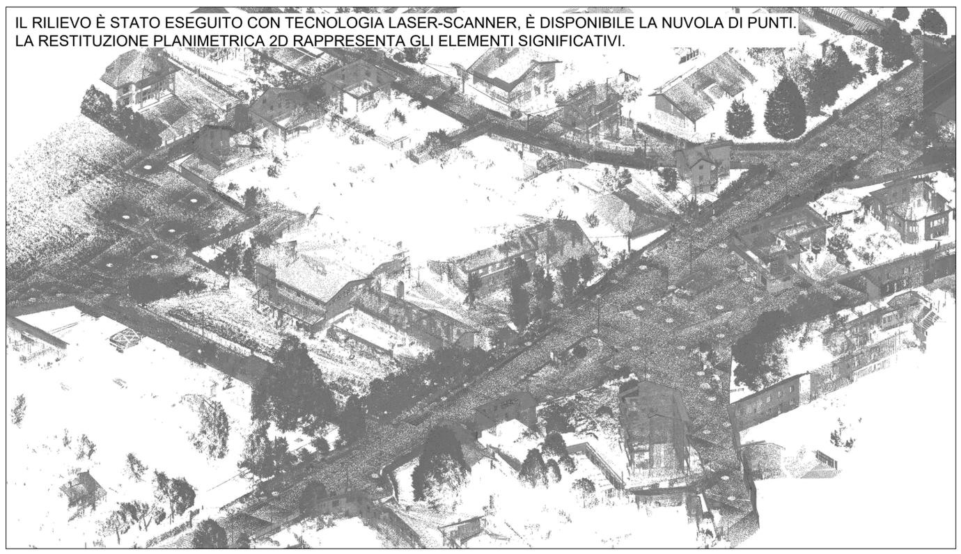
IL RILIEVO È STATO ESEGUITO CON TECNOLOGIA LASER-SCANNER, È DISPONIBILE LA NUVOLA DI PUNTI.
